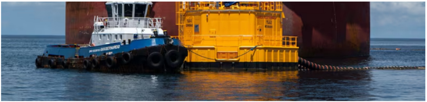
Un buque cargando petróleo crudo para su exportación a través de un oleoducto submarino y una boya de amarre en el puerto de Genits Coveas, filial de Ecopetrol . (Carlos Parra Ríos)
