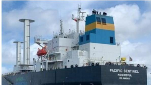
La compañía **Ecopetrol** implementó una operación de transporte marítimo utilizando una embarcación equipada con un sistema auxiliar de propulsión eólica. Dicha tecnología está basada en **velas de succión**, y permiten reducir en un 49% las emisiones de dióxido de carbono en comparación con otros buques.
