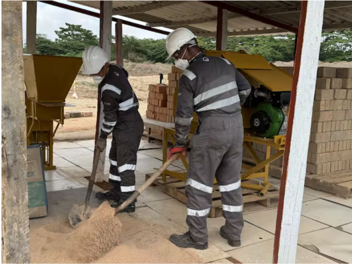
Eliminar el proceso de cocción en la fabricación de los bloques y crear una mezcla que reutiliza desechos provocados por las operaciones de la compañía marcan la diferencia en la elaboración de estos ecobloques. | Foto: Ecopetrol
