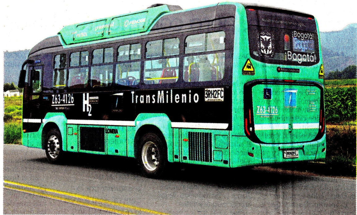
Los buses de hidrógeno verde se cargan en aproximadamente 15 minutos. Se espera que cada uno de estos vehículos logre reducir 1.083 toneladas de emisiones de CO2 en ocho años. FOTO: MARCOPOLO SUPERPOLO
