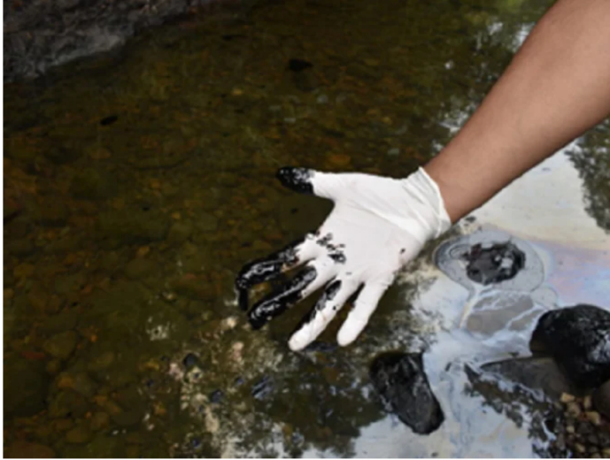
Se observa una alta acumulación del hidrocarburo espeso, prácticamente en estado puro sobre las piedras del río, las riberas y plantas. Así mismo, líquidos corroidos y escorrentías de pozos de petróleo. Allí también se observa el clásico multicolor que indica la presencia de aceite o gasolina flotante sobre las superficies de agua.
