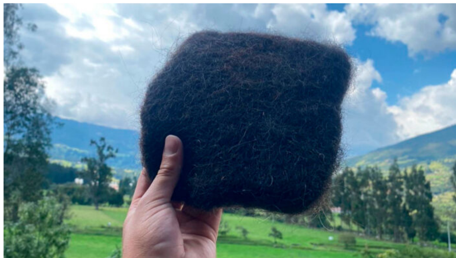
Ecolocos, la esponja de cabello humano para recoger residuos de hidrocarburos, ganó concurso de innovación de Ecopetrol. Foto: Ecopetrol
