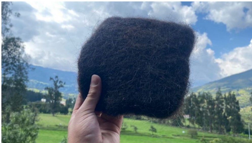
Foto: Ecopetrol / Ecolocos consiste en una esponja hecha de cabello humano, capaz de absorber hidrocarburos en cuerpos hídricos.
