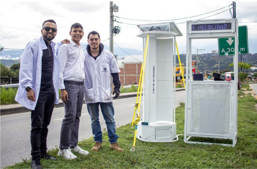
— Foto: Ecopetrol / El sistema comprende una serie de hélices de aluminio que se mueven con las ráfagas de viento expulsadas por los carros al transitar y permite generar energía.
