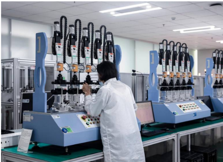
Otra de las máquinas donde se ponen a prueba los celulares de Oppo ante caídas. FOTO Cortesía
