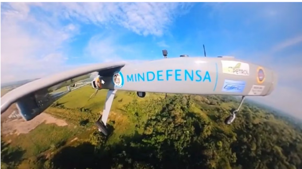
La Aeronave Remotamente Tripulada QUIMBAYA, está fabricada en materiales compuestos ( fibra de carbono aeroespacial), lo que le permite tener buena relación entre el peso de la aeronave versus potencia, optimizando su rendimiento. Todo el desarrollo de diseño, producción e integración del sistema es nacional. | Foto: Cortesía CIAC.
