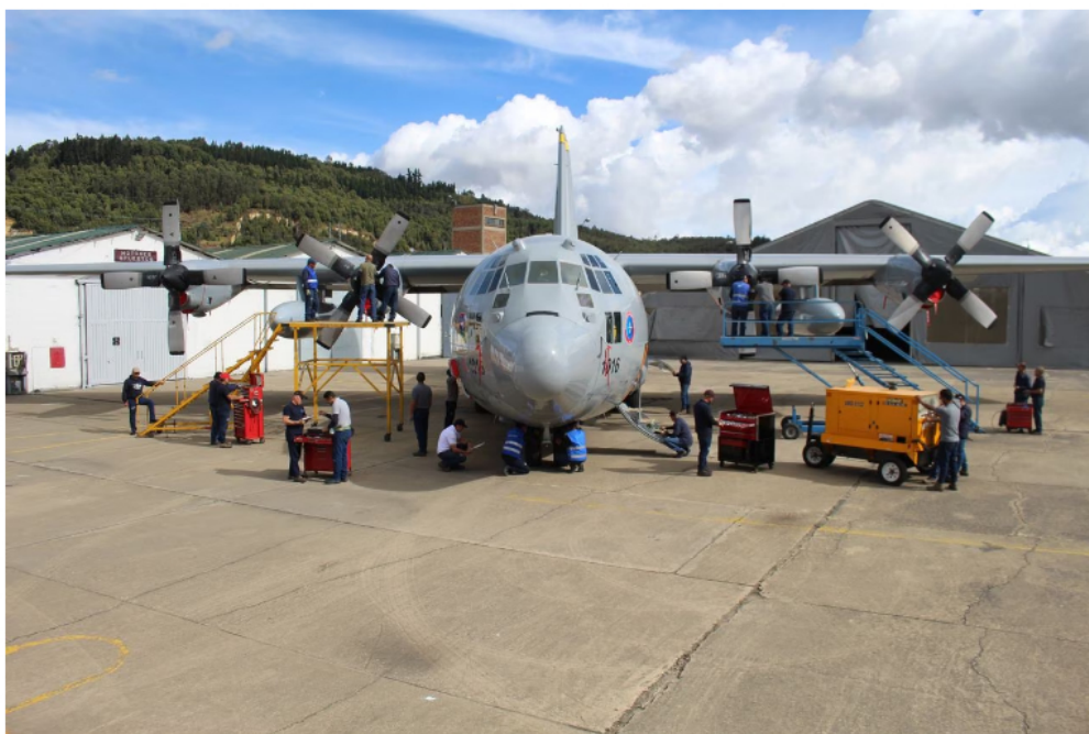
Servicio de PDM, isocronales, home station check, cambios estructurales y pintura, entre otro, son los servicios prestados a las aeronaves C-130 que permiten una extensión en su vida útil y un alto alistamiento de flota. | Foto: Cortesía CIAC.
