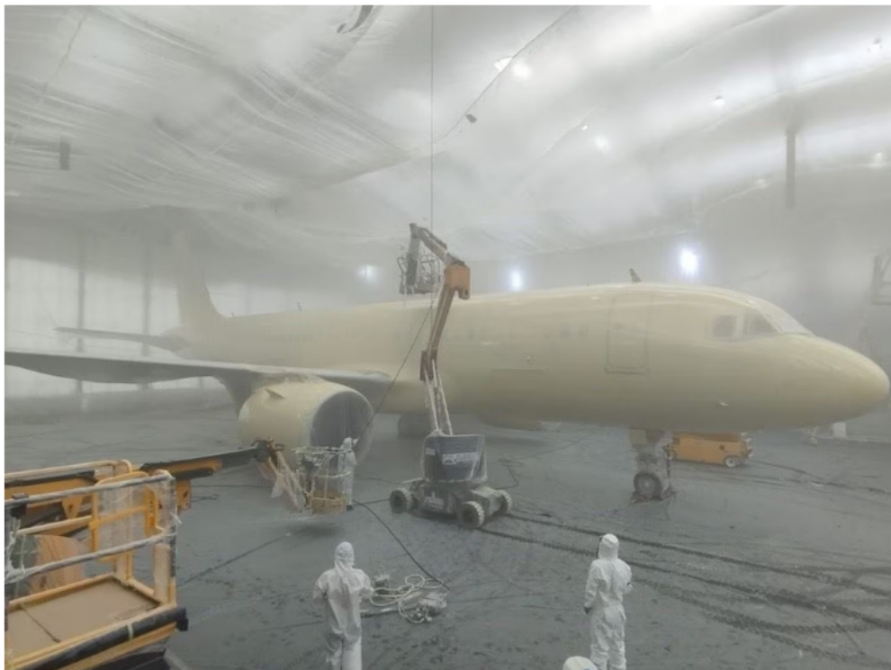
Servicio de mantenimiento mayor, pintura, alteraciones estructurales, reparaciones en materiales compuestos, entre otros, son los servicios que presta CIAC S.A, a las aeronaves Airbus 320 Family. | Foto: Cortesía CIAC.
