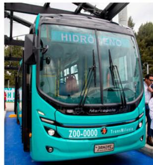
En el ensamblado, efectuado en Colombia, participaron más de 100 profesionales y técnicos que lograron un vehículo con autonomía superior a 450 kilómetros con una sola recarga al día y puede alcanzar una velocidad máxima de 90 km/h.
