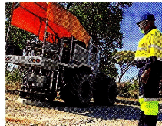
Cada tractor puede ejercer una fuerza de 390.000 kilos contra el suelo de la selva.
