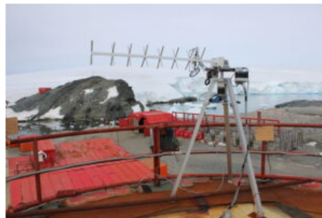
A foto mostra uma antena de satélite portátil, durante um teste na estação terrestre temporária do FACSAT-1, na Base General Bernardo O'Higgins, do Exército chileno, em 19 de janeiro de 2020. (Foto: CITAE da Força Aérea Colombiana)
