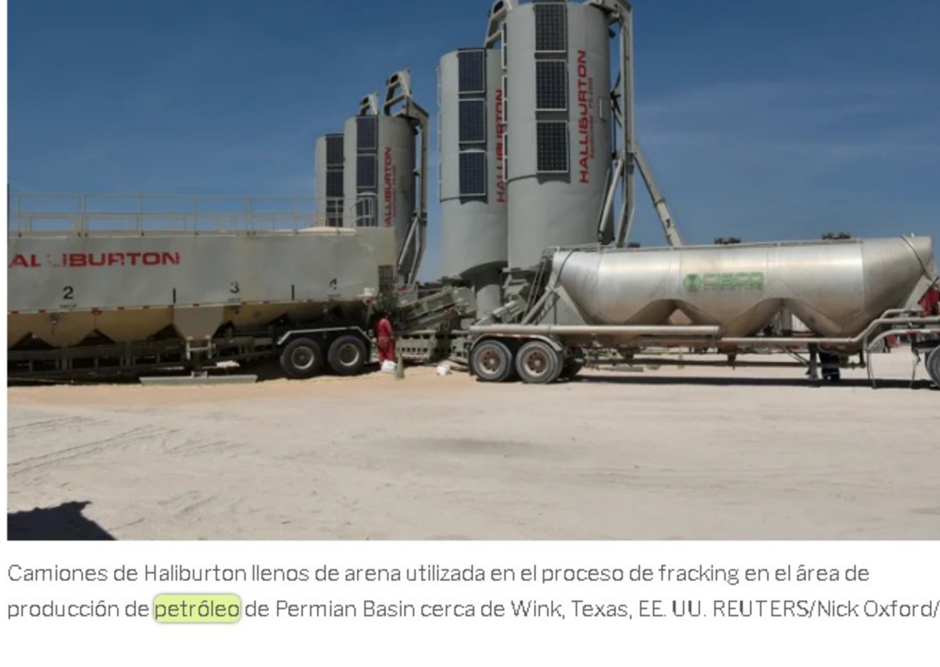
Camiones de Halliburton llenos de arena utilizada en el proceso de fracking en el área de producción de petróleo de Permian Basin cerca de Wink, Texas, EE. UU. REUTERS/Nick Oxford/
