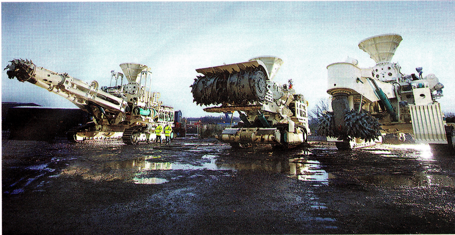
Las máquinas que realizan pruebas en el fondo marino, y que se usarían en la explotación minera, pueden pesar unos 30.000 kg. / Cortesía - Nautilus Minerals
