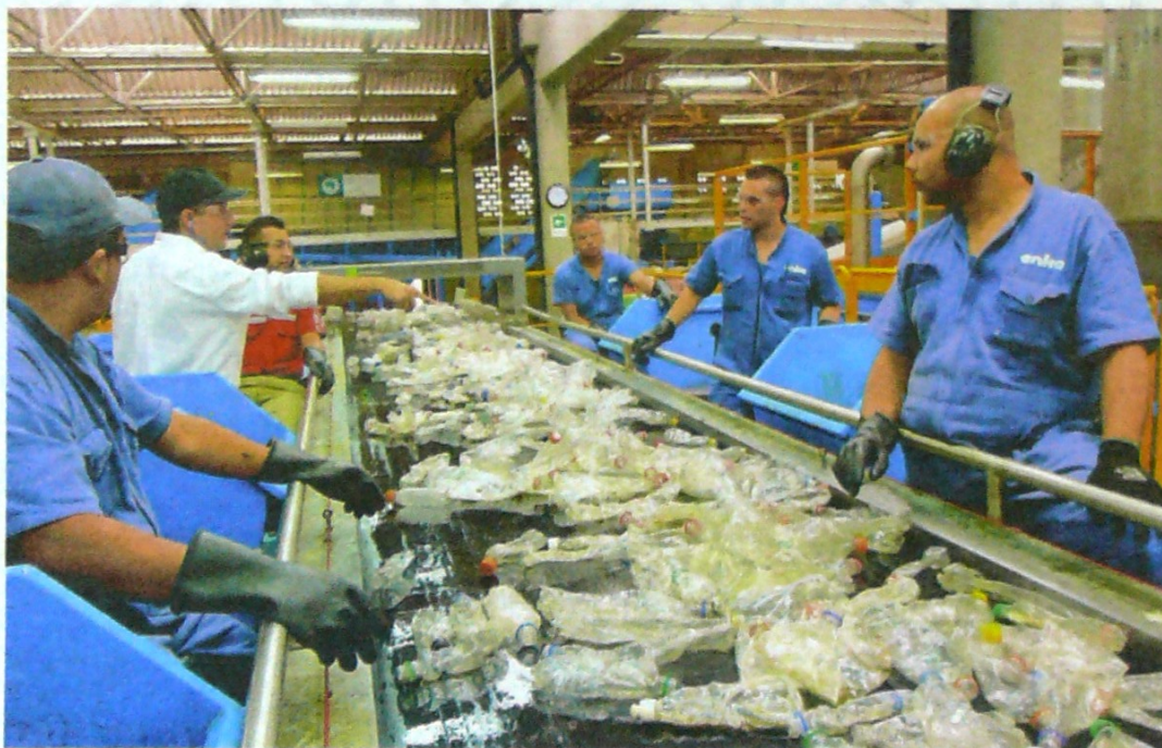
Cada año Enka procesa 1.025 millones de botellas PET que se convierten en materia prima para elaborar nuevos envases y fibras para la confección de prendas. FOTO JULIO CÉSAR HERRERA
