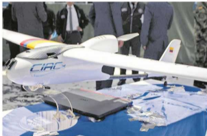
El Coelum mini UAV cuenta con una cámara con zoom óptico de 20x y zoom digital de 40x y un sensor infrarrojo. Foto: CIAC
