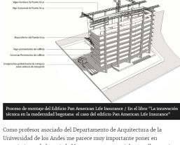
Proceso de montaje del Edificio Pan American Life Insurance / En el libro "La renovación técnica en la modernidad bogotana: el caso del edificio Pan American Life Insurance"
