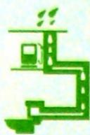
Sistema de aprovechamiento de aguas lluvias a través de un biocaptador, para luego utilizarlas en sanitarios y riego de jardines.
