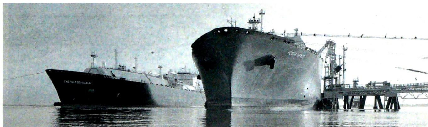
Los buques que traen el GNL al país tienen una capacidad que oscila entre los 90.000 y 120.000 metros cúbicos. Cortesía
